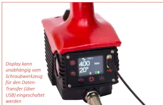
Display kann unabhängig vom Schraubwerkzeug für den Daten-Transfer (über USB) eingeschaltet werden
