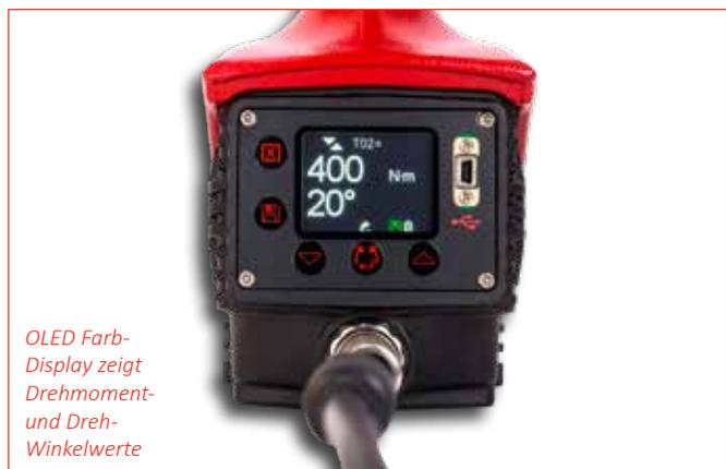
OLED Farb-Display zeigt Drehmoment- und Dreh-Winkelwerte
