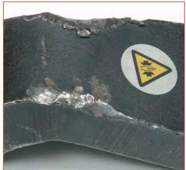
*An diesem beschädigten Fuß sind Anzeichen einer schlechten Reaktion erkennbar. Die Reaktion wurde an der falschen Stelle des Fußes durchgeführt und das Entgraten zeigt an, dass der Fuß vom Reaktionspunkt gerutscht ist.*
